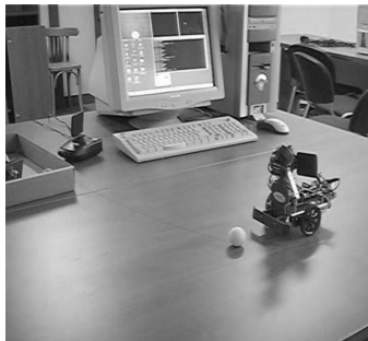
Obr. 1. Mobilný robot vybavený dvojkolesovým podvozkom a kamerou
