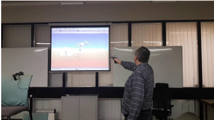
Obr. 1. Strelba na avatara s laserovej pištole. Herné prostredie je premietané na plátno, ktoré sníma kamera, ktorú na obrázku vidno vľavo dolu.
